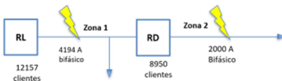
Figura 2 - Transferência de curto-circuito para a zona 1
