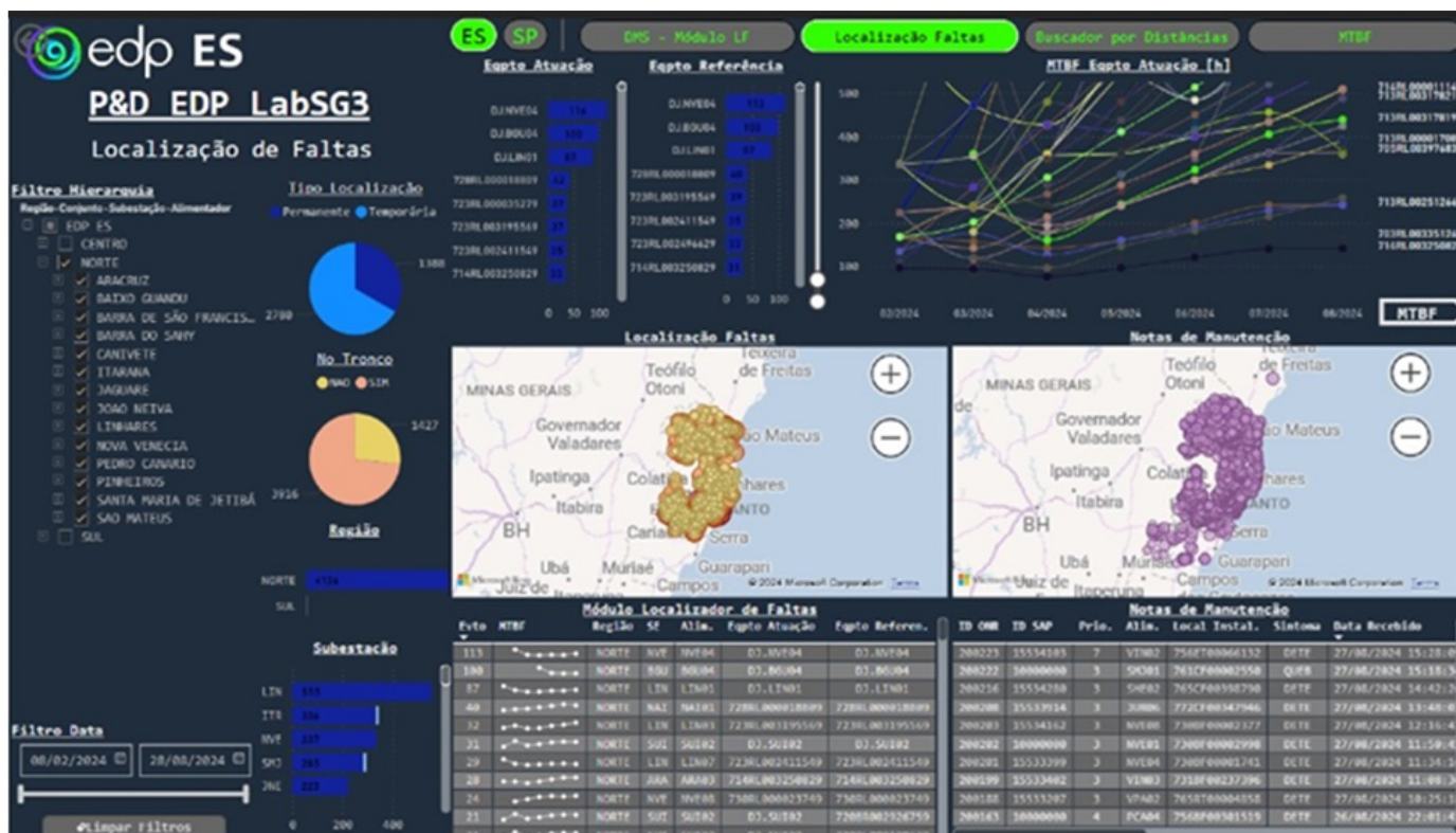
Figura 4 - Tela do Power BI para visualização das faltas e cruzamento dos dados com as notas de manutenção.
