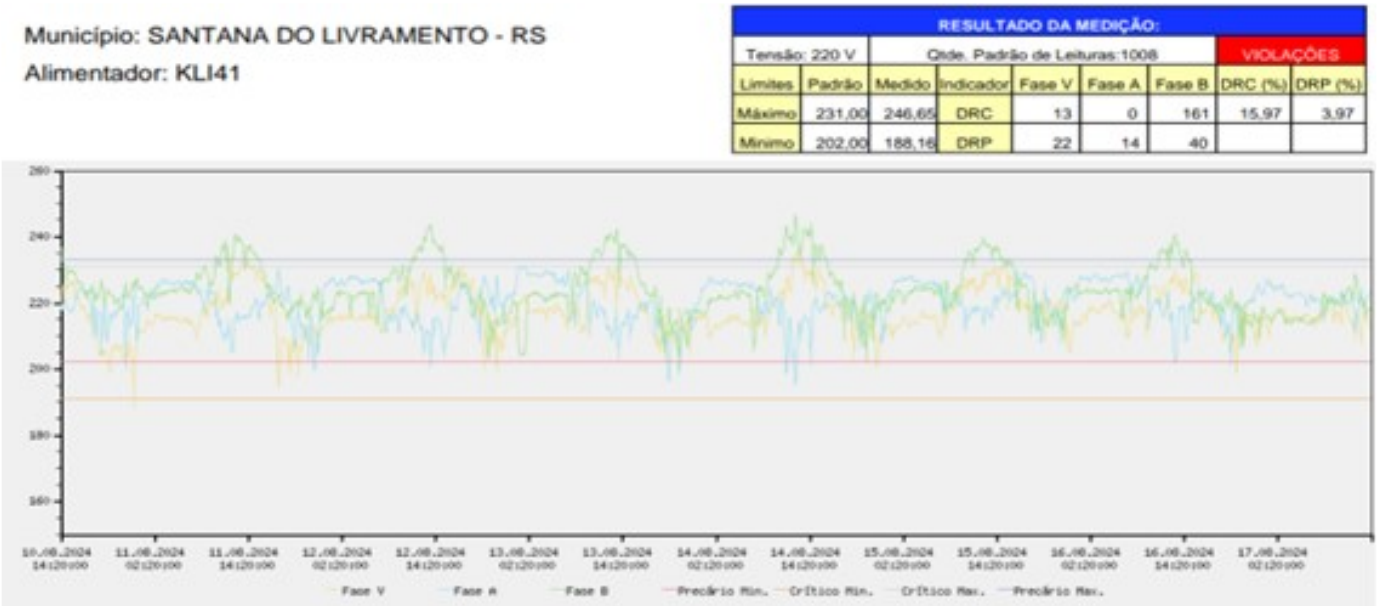
Figura 2. Medição prévia no circuito de BT com violação de níveis de tensão.
