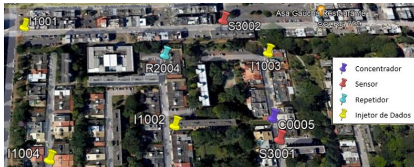
Figura 6 - Localização dos dispositivos instalados na 1ª Fase na Asa Norte (Brasília)
